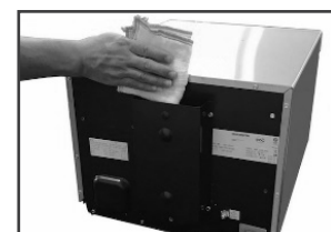
Otwory wentylacyjne wylotowe
